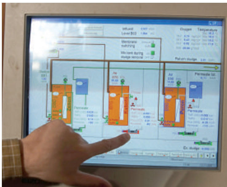
Prozessleitsystem der Membrankläranlage in Dübendorf (links). Eawag-Mitarbeiter Marc Böhler und Martin Holzapfel von Terralink demonstrieren eine Hohlfaser- sowie eine Plattenmembrane. Das verschmutzte Abwasser passiert die feinen Fasern und wird dabei filtrierte. Zurück bleibt eine Deckschicht aus Schlamm, während das gereinigte Wasser aus dem Innern der Membranen abfließt.
